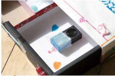
引き出しの中に明るさブロックを設置。引き出しを開けると、センサーが作動し音楽や音声が流れる。ランダムに流れるように設定されているので、どんな音が出るかは開けてからのお楽しみ。
