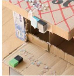
ボタンブロックを押すと、友だちと一緒に歌った歌が流れる。さらに、引き出しに動きブロックを設置し、引き出しを開けるたびに運試しのおみくじが行われる。
