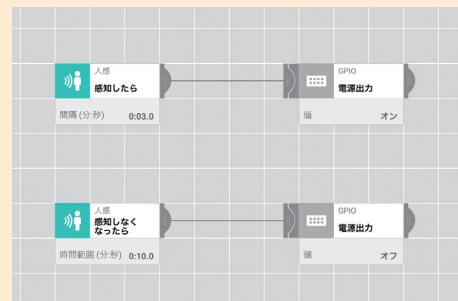
プログラムができあがったら、最初に自分たちで考えた明かり（照明器具）となっているか、実際の回路で動作を確かめる。このときに使うMESHブロックは、人感ブロックだけでなく、動きブロックなどを使ってもよい。
